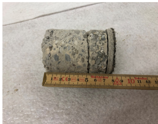
Abb. 38: Bohrkern Nadelfilz (Korridor 1.UG)
